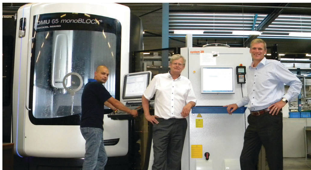
(V.l.n.r.) Operator Marco Evers, managing director Leo Spaan en bedrijfsleider Ton Göbel bij de nieuwste manloze productiecel, bestaande uit een DMU 65 Monobloc bewerkingscentrum van DMG Mori met 24 Dynafix pallets en een Workmaster handlingrobot van System 3R.
